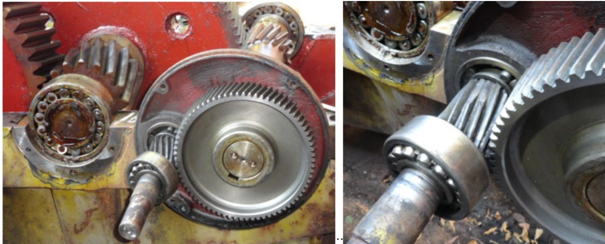
Fig. 3. Treaptă cilindrică cu dinți înclinați montată suplimentar la intrarea în reductorul mare
