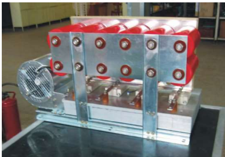
Fig. 10 Punte cu tranzistoare IGBT
