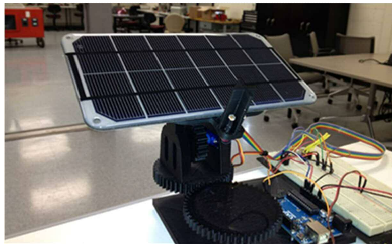
Fig. 3. Tracker solar fotovoltaic pe doua axe
