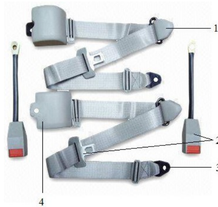
Fig. 5 Elementele componente ale unei centuri de siguranță cu prindere în trei puncte. în care: 1 este catarama care vine prinsă în partea de sus a stâlpului mașinii (catarama D); 2 este catarama necesară prinderii sau desfacerii centurii (catarama B); 3 este catarama poziționată în partea de jos a stâlpului mașinii (catarama A); 4 este retractori.
